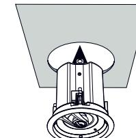
**9-** Für den nächsten Schritt benötigen Sie die im Lieferumfang des Lautsprechers enthaltenen Klemmenleistenstecker. Lösen Sie die Drahtsicherungsschrauben völlig.
